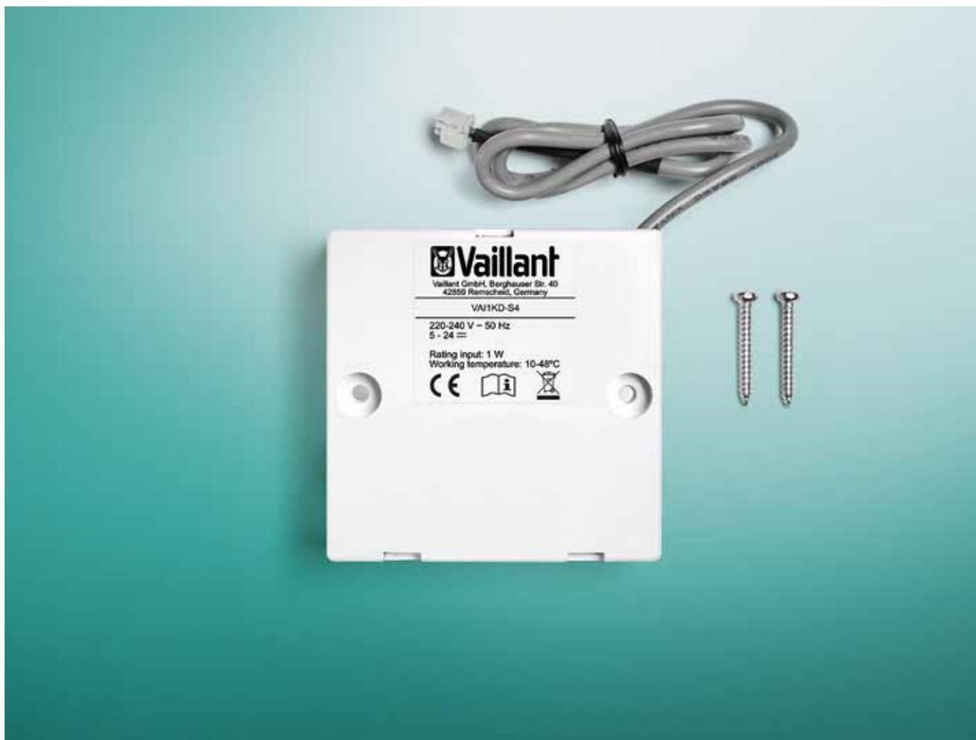
La scheda con scatola a filo VAI1KD-S4 (art. 0010030968) consente all'unità interna di climatizzazione di attivarsi o disattivarsi attraverso un segnale elettrico 220 Vac o attraverso un segnale a bassa tensione 5-24 Vdc.
