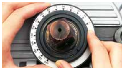
Regolazione dell'angolo di curvatura senza utensili
