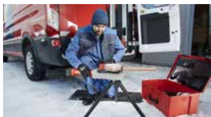
Regolazione dell'angolo di curvatura senza utensili
