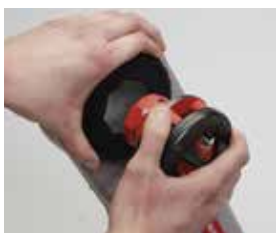
Semplice inserimento della testina grazie alla presenza di un anello di tensione
