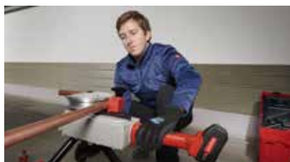
Segmenti di curvatura in alluminio forgiato con scala di curvatura integrata
