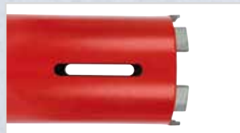
Presca d'aria sulle corone da 150mm per prevenire l'accumulo di polvere e il surriscaldamento della corona
